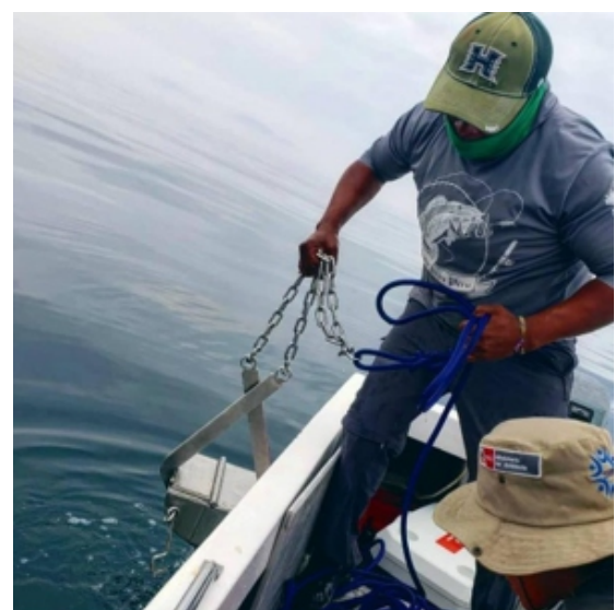
Proceso de muestreo de sedimentos utilizando una draga Van Veen
